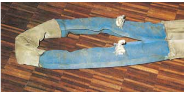
Bild 23-18: Aufgeriebene Schutzhülle. Da auch die Einlage zerstört ist, ist keine Reparatur möglich
