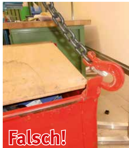
Bild 16-4: Haken rutschen bei Schlaffketten aus den Ösen
