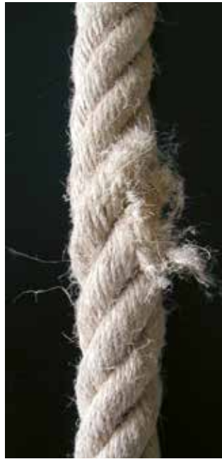
Bild 23-7: Zerstörung einer Litze
