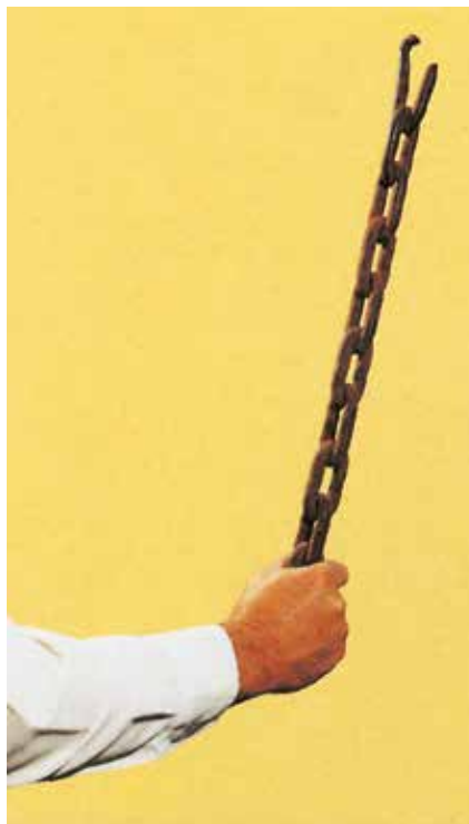
Bild 23-11: Durch Überlastung steif gezogene Kette
