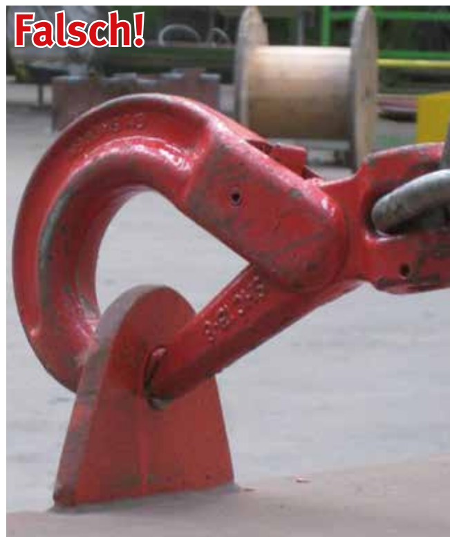
Bild 22-2: Haken ist in eine zu kleine Öse eingehängt. Haken und Öse werden verbogen. Außerdem besteht die Gefahr des unbeabsichtigten Aushängens.
