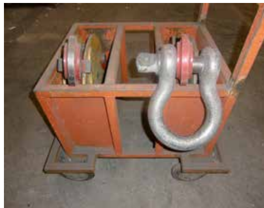
Bild 24-2: Abgestellte, gegen Umfallen gesicherte Lastaufnahmemittel
