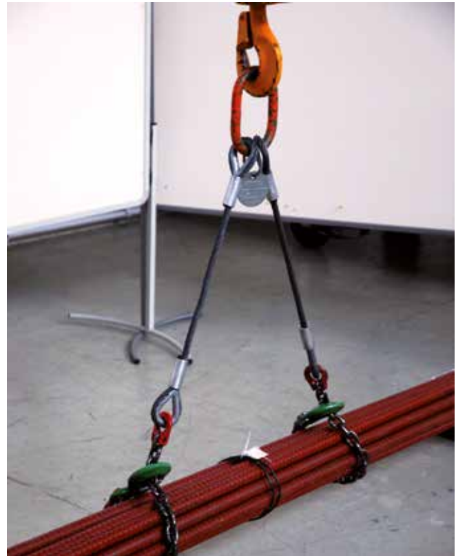
Bild 6-1: Kombination Seil/Kette zur Schonung der Drahtseile
