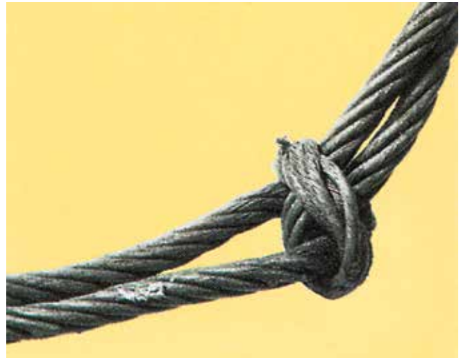
Bild 9-2: Unzulässiger Knoten zerstört den Seilverbund
