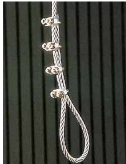
Bild 9-4: Fertig zum Einsatz! Alle Klemmbacken sitzen auf dem tragenden Strang
