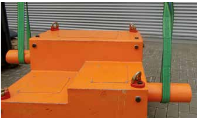
Bild 6-2: Hebebänder sind oberflächenschonend
