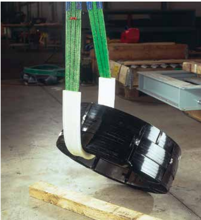
Bild 10-2: Nur der verschiebbare, innen armierte Polyurethan-Schutzschlauch mit starker, mindestens 5 mm dicker Beschichtung ermöglicht das gefahrlose Wenden des Coils, wenn das Band deutlich länger ist als der Kantenschutzschlauch
