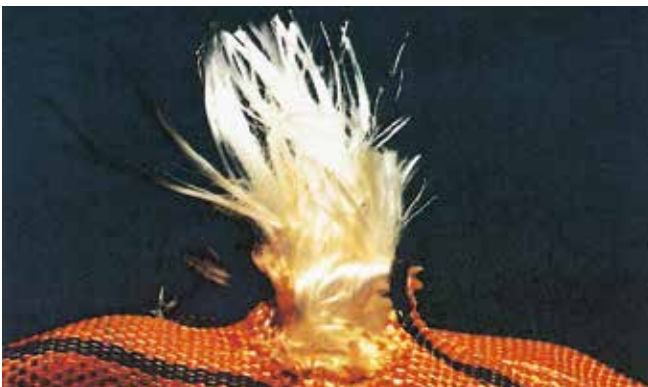
Bild 23-15: Durch Schnitte beschädigte Ummantelung und Einlage einer Rundschnelle
