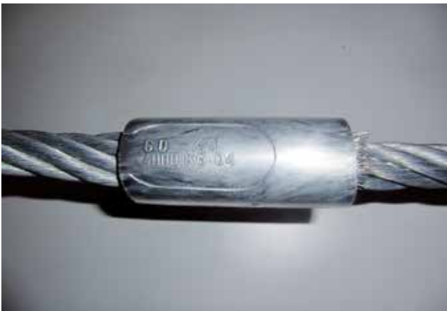
Bild 9-1: Pressklemme mit Verpresserkennzeichen
